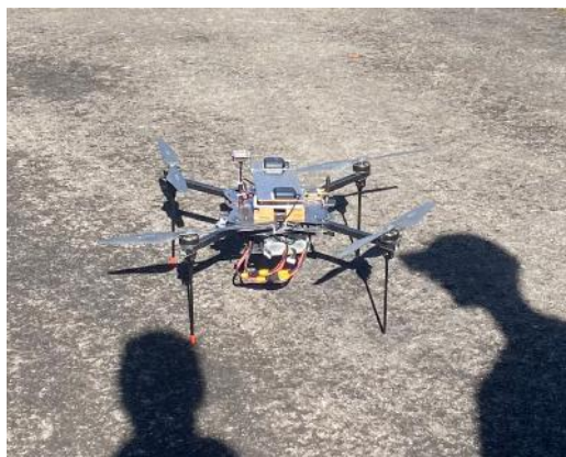
GPS-Jamming-Test an einer Drohne
