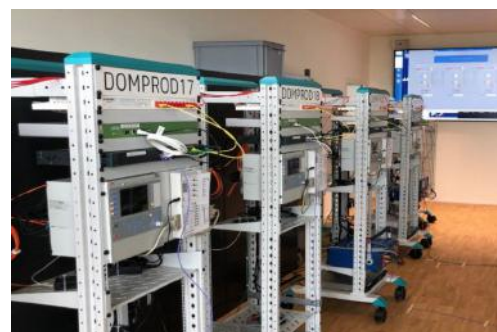
Krinflab: Rekonstruktion eines Schweizer Energieunterwerks zur Entwicklung von Angriffs- und Abwehrstrategien.
