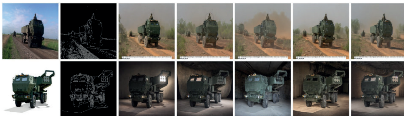
Synthetische Bilderzeugung mit Stable Diffusion am Beispiel eines HIMARS Lenkwaffenwerfers. Von links nach rechts: Originalbild, Kantenbild (Canny-Edge Map), fünf verschiedene synthetische Beispiele. Das Kantenbild dient als Input für Stable Diffusion und garantiert, dass die Geometrie des Fahrzeugs möglichst erhalten bleibt. Stable Diffusion kann nun das Originalbild so verändern, dass das Fahrzeug in einer anderen Umgebung erscheint als auf dem Originalbild. Bedrohungsakteure könnten in Zukunft einen solchen Ansatz in Kombination mit einer gezielten Verbreitung über die sozialen Medien zur militärischen Täuschung einsetzen.
