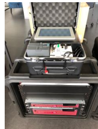
Industrielles Steuerungssystem mit Visualisierungsanzeige (oben) und mobilem Cyberbereich (unten)
