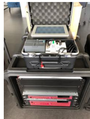
Système de commande industriel avec écran de visualisation (en haut) et espace cyber mobile (en bas)
